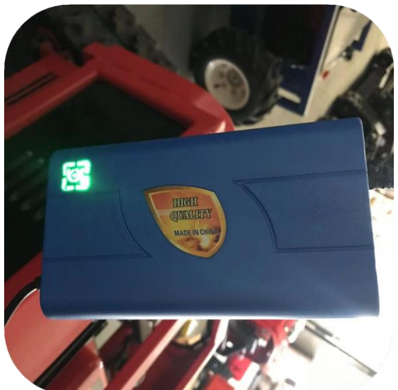
Schritt 4: Das grüne Licht leuchtet und der Akku ist vollständig geladen.
