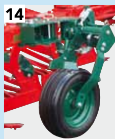
14 Rad-Ø 600 mm luftbereift x 220 mm Breite - VORNE montiert, schwere Ausführung (doppelstielig). Verfügbar für: Für alle 5- und 6-scharigen Pflüge
