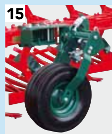
15 Rad-Ø 680 mm luftbereift x 250 mm Breite - VORNE montiert, schwere Ausführung (doppelstielig). Verfügbar für: Für alle 5- und 6-scharigen Pflüge
