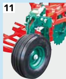
11 Rad-Ø 680 mm luftbereift x 250 mm Breite Verfügbar für: XMS/XS (nicht für 6-scharige sowie 5-scharige ST und/oder Vario-Pflüge)
