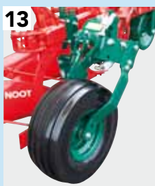
13 Rad-Ø 680 mm luftbereift x 250 mm Breite – schwere Ausführung (doppelstielig) Verfügbar für: Alle 6-scharigen sowie 5-scharigen ST und/oder Vario-Pflüge
