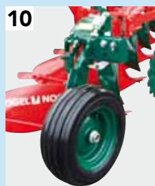
10 Rad-Ø 600 mm luftbereift x 220 mm Breite Verfügbar für: M/XM/ XMS/XS (nicht für 6-scharige sowie 5-scharige ST und/oder Vario-Pflüge)
