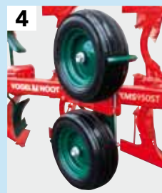
4 Rad-Ø 600 mm luftbereift x 220 mm Breite Verfügbar für: XMS- und XS-Pflüge mit Rahmenhöhe 82
