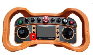
Schritt 2: Netzschalter einschalten
