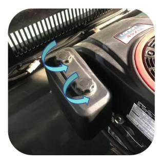
**Schritt 2:** Herausnehmen des Luftfilters zum Reinigen oder Ersetzen
