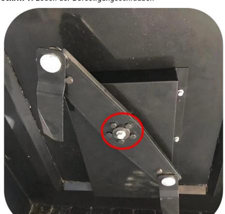
Schritt 1: Lösen der Befestigungsschrauben
