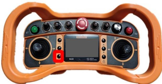
**Schritt 4:** Mit dem Joystick auf der Fernbedienung nach links und rechts steuern, um das Fahrzeug herunterzufahren
