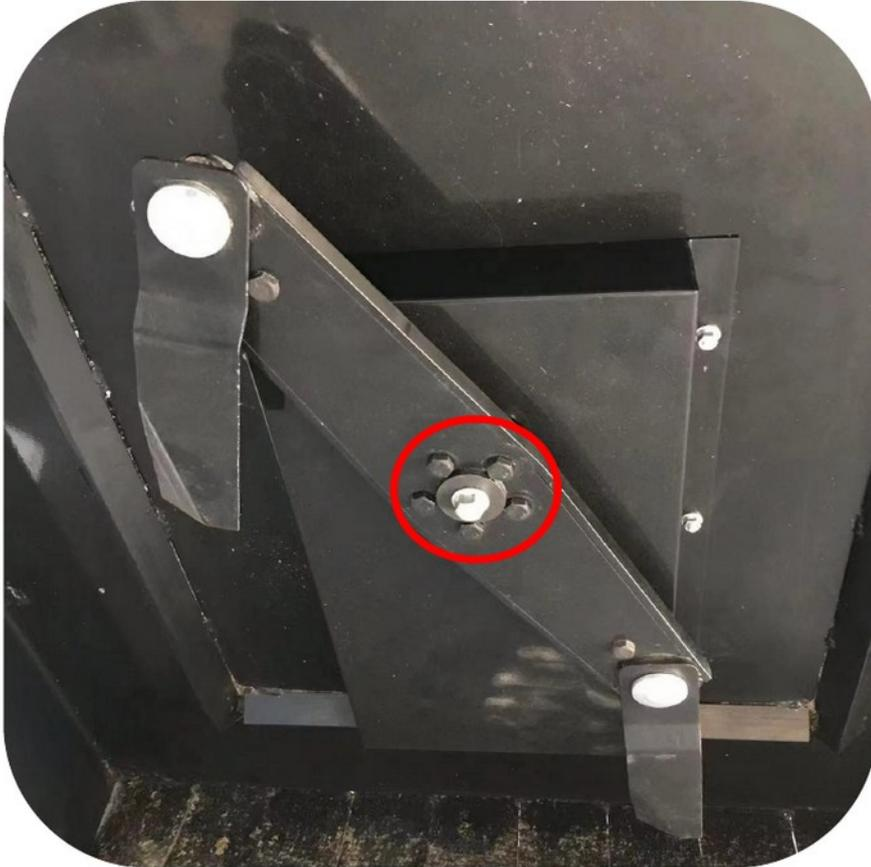
*Schritt 2: Messer-Befestigungsmutter lösen, das Messer durch ein neues ersetzen und wieder festschrauben*
