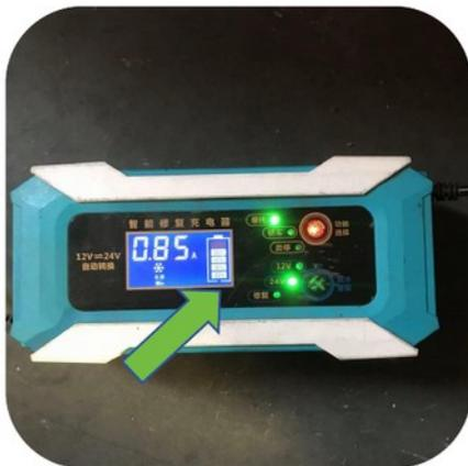
**Schritt 4:** Batterie ist vollständig geladen und zeigt 100 % an
