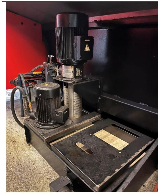
Die Maschine hat sowohl eine Außenkühlung als auch eine Hochdruckinnenkühlung durch die Spindel. Deshalb auch die zwei Pumpen.
