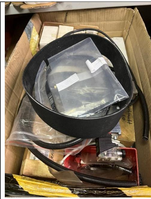
Für die Maschine sind verschiedene Ersatzteile, die sich im Laufe der Jahre angesammelt haben, vorhanden. Zum Beispiel ein neuer Antriebsriemen, ein neuer Zahnriemen für die Spindelpositionierung, diverse Knöpfe, Näherungsschalter uvm.
