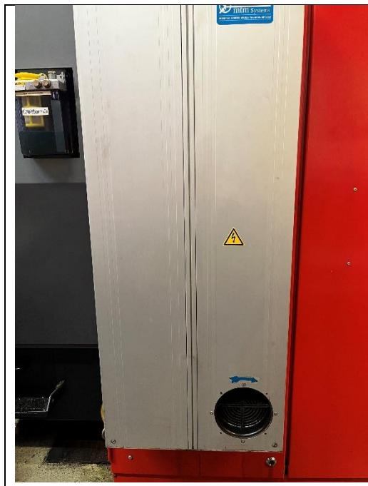
Die Maschine verfügt über ein Schalschrankkühlgerät, um die Elektrokomponenten als auch die Steuerung vor Überhitzung zu schützen.
