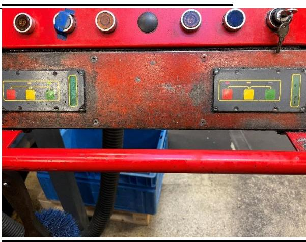
Betätigungsstangen für die Magneten links/rechts auf dem Bedienpult montiert.
